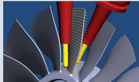
**Точечный контакт с пером лопатки импеллеров и блисков:** Стратегия точечного контакта с пером лопатки является стратегией высокоскоростного резания, с помощью которой можно отлично фрезеровать перья лопаток с любой степенью изогнутости.
