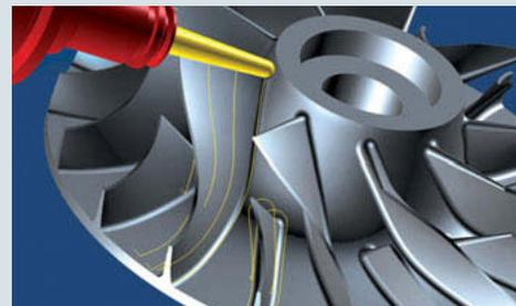
**Обработка кромок импеллеров и блисков:** Эта стратегия обработки всегда применяется в случаях, когда входные или выходные кромки лопаток не могут быть сгенерированы за один раз с помощью использования параметрических поверхностей.
