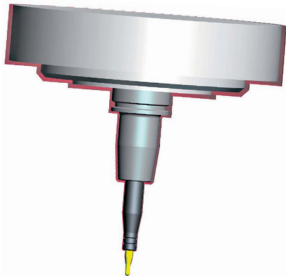
Definition mit Sicherheitsaufmaß
