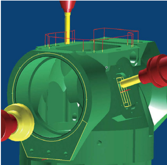
Verschobene und gekippte Arbeitsebene
