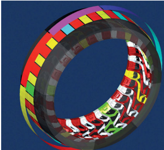
Anordnung identischer Reifenabschnitte
