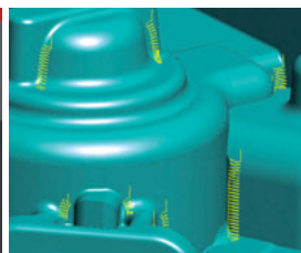
Bearbeitung von durchweg steilen Bereichen
