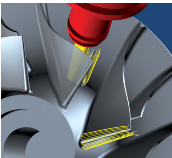
Bearbeiten der Ein- und Austrittskante
