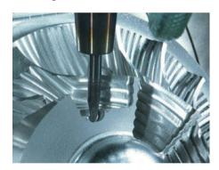
Prozesssicher: Der Einsatz stabilerer Werkzeuge erlaubt das Fräsen mit hohen Zustellparametern und Vorschüben. Die vielfach bewährte Kollisionskontrolle von hyperMILL® garantiert hier eine sehr hohe Prozesssicherheit. Dabei kann der Anwender zwischen zwei Strategien wählen: Kollisionsvermeidung um die Z-Achse oder senkrecht zur Camber-Line, einer gekrümmten Kurve zwischen zwei Blättern. Die optimale Werkzeugorientierung schafft Raum für den Einsatz dicker Werkzeuge.
