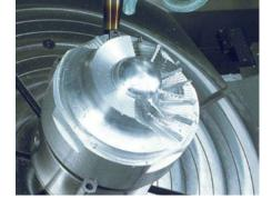
zusätzliches CAM-Produkt genutzt werden können. Zudem sind bei den Impeller-Blisk-Zyklen auch konische Werkzeuge einsetzbar.
