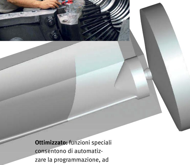
**Ottimizzato:** funzioni speciali consentono di automatizzare la programmazione, ad esempio la funzione Rolling Ball per la fresatura di raggi di transizione, la funzione Best Fit per la determinazione automatica della posizione di inizio ottimale per la finitura, oppure la correzione automatica dell'angolo di anticipo per la prevenzione delle collisioni.
