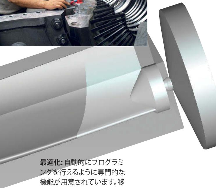
**最適化:**自動的にプログラミングを行えるように専門的な機能が用意されています。移動半径の加工用のローリングボール、仕上げプロセスに最適なスタート位置を自動設定するベストフィット機能、干渉回避の自動リード角補正機能
