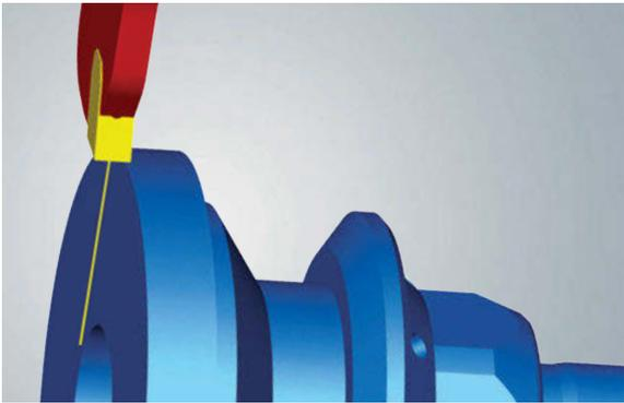
**Tronçonnage** : cette stratégie consiste à tronçonner la pièce dans la matière première. Le tronçonnage peut être réalisé sur la pièce avec un chanfrein.
