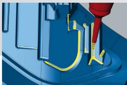
**Ripresa 3D automatica del materiale residuo per percorsi utensile omogenei**
