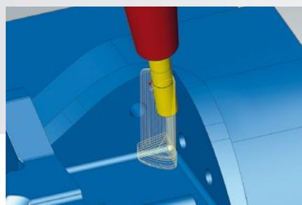
**Ripresa del materiale residuo A 5 assi per una lavorazione angolare efficiente**
