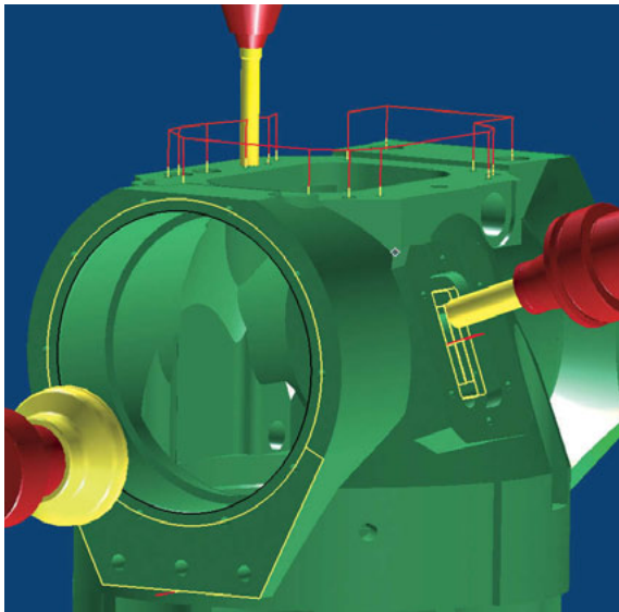
Plans de travail déplacés et basculés
