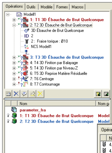
Gamme d'usinage avec gestion des ébauches
