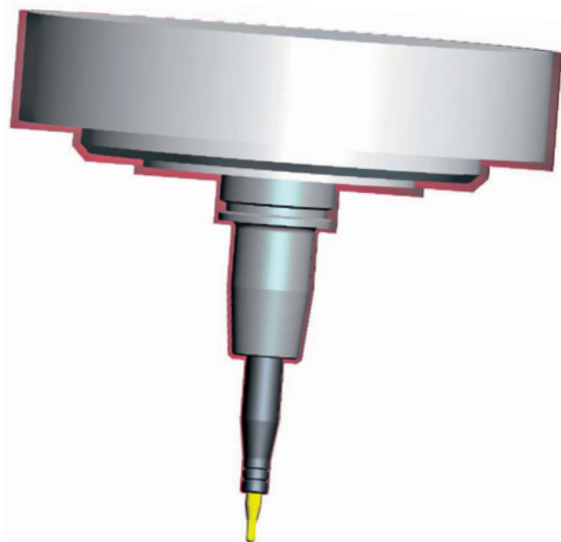
Définition de l'outil avec la surépaisseur de sécurité en rouge
