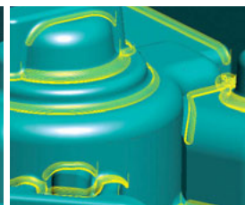
Usinage de zones planes uniquement
