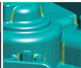
Usinage de zones à fortes pentes uniquement
