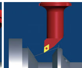
Angle de sécurité pour la protection de l'arrêt de coupe
