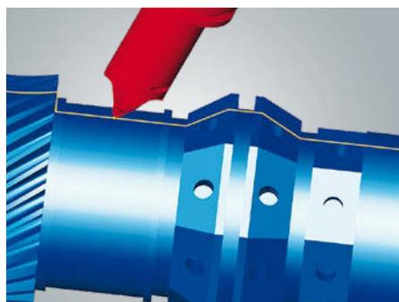
**Finition :** le déplacement en simultané de l'axe B permet d'effectuer la finition de contours complexes en une seule étape, ce qui évite les changements d'outil ainsi que les bords visibles
