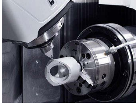
DMG MORI CTX torna-freze makinesinde tam makineyle işleme
