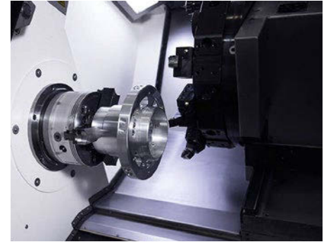
Siemens kontrolörlü DMG MORI CTX alpha 500 üzerinde taretli torna
