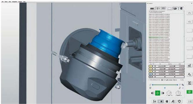
**NOUVEAU :** Dans *hyperMILL SIMULATION Center* et dans la machine virtuelle, les géométries en rotation sont représentées en tant que telles
