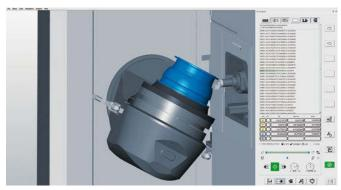
NOVITÀ: in hyperMILL SIMULATION Center e nella macchina virtuale, le geometrie rotanti vengono visualizzate in quanto tali
