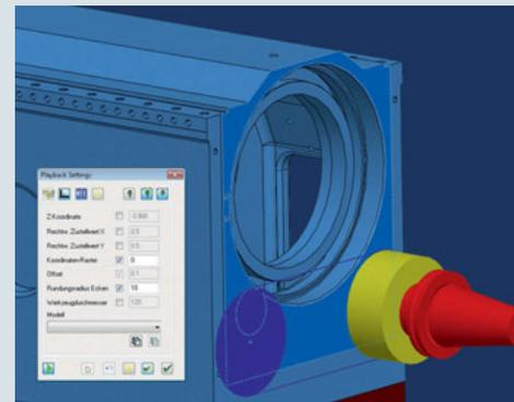
**Fresatura playback:** I lavori di fresatura più semplici sono eseguibili mediante la fresatura playback. In questa modalità, il percorso di fresatura viene generato specificando il diametro di fresatura e facendo scorrere il mouse sulle aree corrispondenti.
