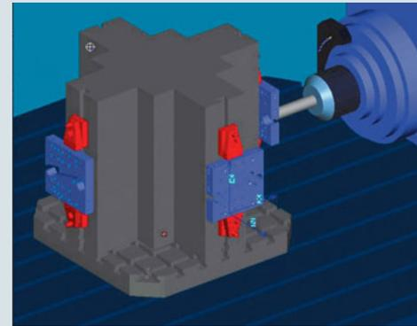
**Staffaggio multiplo:** Questa funzione consente la lavorazione di pezzi da diverse direzioni senza un cambio di staffaggio. Grazie alla funzione di ripetizione di parti del programma, è possibile eseguire sulla macchina parti del programma anche con il piano di lavoro spostato o inclinato.
