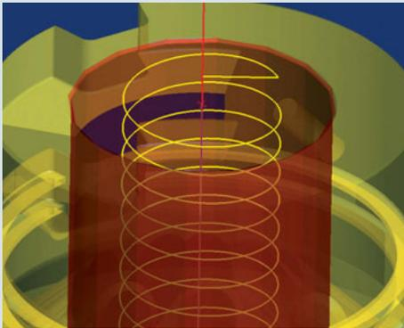
**Foratura elicoidale:** Nella foratura elicoidale, la fresa effettua un percorso a spirale verso il basso. L'angolo di inclinazione della spirale può essere definito liberamente dall'utente entro limiti tecnologicamente utili. Con la filettatura vengono prodotti filetti interni o esterni. L'opzione di foratura profonda consente di eseguire la fresatura di fori particolarmente profondi.
