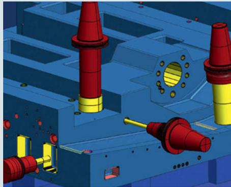
**Foratura multiasse:** La foratura multiasse consente di programmare rapidamente e con facilità forature con diversi angoli di incidenza dell'utensile in un'unica operazione. Una funzione automatizzata è in grado di calcolare autonomamente l'incidenza dell'utensile e collega i punti di arrivo delle forature ottimizzando i percorsi.
