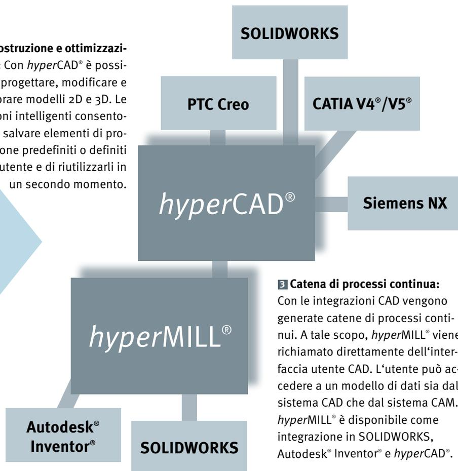
**3 Catena di processi continua:** Con le integrazioni CAD vengono generate catene di processi continui. A tale scopo, *hyperMILL*® viene richiamato direttamente dall'interfaccia utente CAD. L'utente può accedere a un modello di dati sia dal sistema CAD che dal sistema CAM. *hyperMILL*® è disponibile come integrazione in SOLIDWORKS, Autodesk® Inventor® e *hyperCAD*®.
