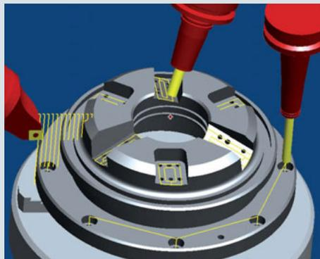
**La quotidianità della programmazione:** In particolare nella quotidianità della programmazione, la possibilità di passare in modo semplice e rapido dalla strategia di lavorazione per la tornitura a quella per la fresatura rappresenta un enorme vantaggio. Grazie all'implementazione completa del modulo di fresatura e tornitura in **hyperMILL®**, l'utente non ha che da selezionare il ciclo desiderato, come ad esempio la sgrossatura e tornitura. Non occorre quindi aprire un ulteriore programma.
