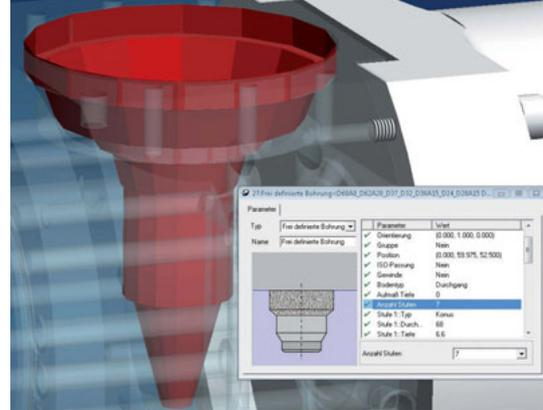
**Feature per forature libere:** Questa funzione consente di programmare forature con lamatura con la massima facilità. È possibile definire in una feature diverse sezioni per la foratura nonché la profondità di foratura.
