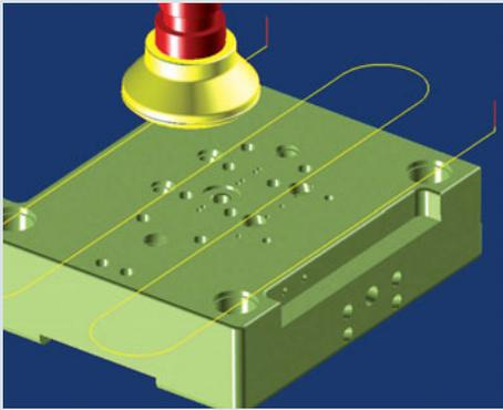
**Spianatura:** La strategia „Spianatura“ consente di eseguire rapidamente e con facilità la lavorazione di aree piane in modalità solo andata o zigzag. È possibile eseguire in un'unica operazione la lavorazione di più superfici indipendenti.
