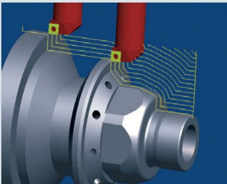
**hyperMILL® millTURN** integra strategie di tornitura per la sgrossatura, la finitura, la lavorazione di gole, la filettatura e la foratura. La sgrossatura può essere eseguita in lunghezza, in piano e parallela al contorno. Nella finitura, diverse macro di affondamento e disimpegno consentono una lavorazione ottimale.
