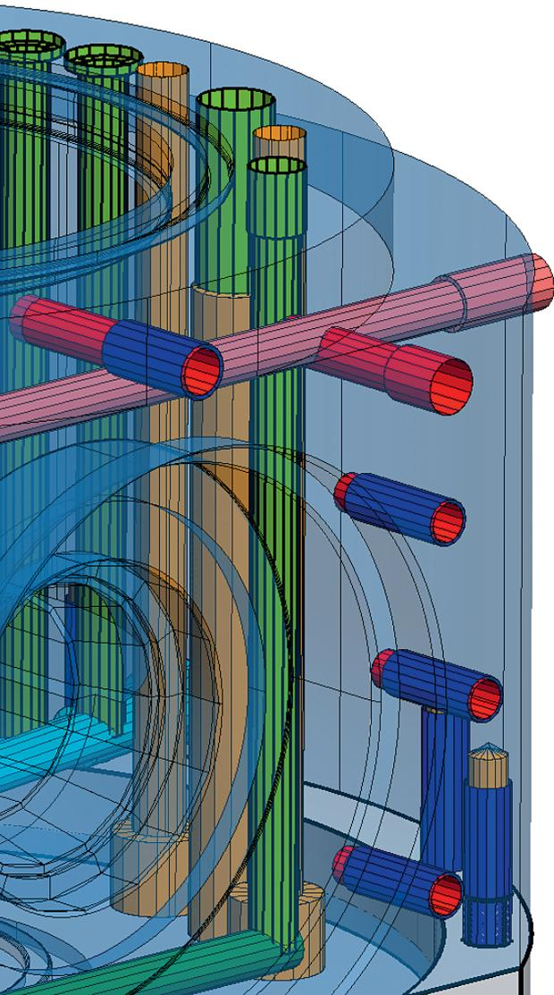
**Feature foratura:** Per la lavorazione con posizionamento multiasse è possibile effettuare la ricerca, all'interno di un'area definita dei pezzi, di forature che presentano lo stesso orientamento o la stessa profondità, oppure un allineamento differente. Le operazioni di foratura possono essere generate sia come centratura che come foratura semplice, foratura rompitrucciolo o maschiatura.
