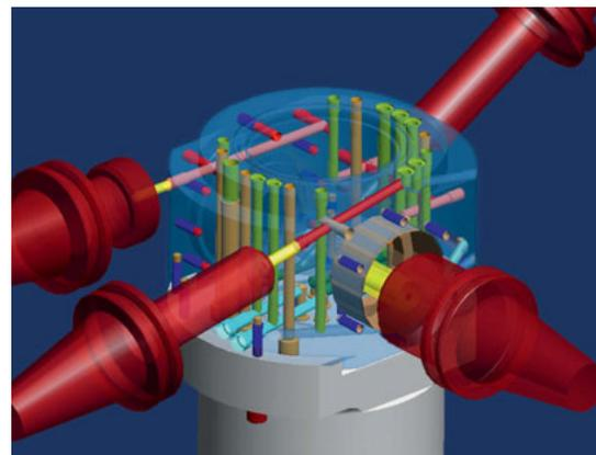
**Feature multiasse:** *hyperMILL*<sup>®</sup> riconosce le geometrie, i contorni e le rispettive posizioni. L'incidenza e il posizionamento dell'utensile vengono generati automaticamente. Un lavoro di foratura con posizionamento multiasse viene calcolato da *hyperMILL*<sup>®</sup> automaticamente a 5 assi con varie incidenze.
