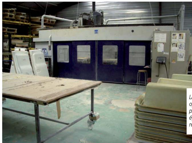
*La machine travaille de jour sur des opérations de détournages et de nuit pour l'usinage des maquettes. Elle est également utilisée avec un palpeur pour réaliser des mesures.*
