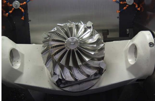
Un impeller finito. La gamma dei diametri proposta da Polygona AG va da 0 a 800 mm; nel caso degli impeller chiusi il diametro massimo è pari a 250 mm.
